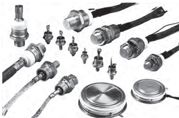
Рис. 10.4. Вигляд різних типів напівпровідникових діодів середньої та великої потужності
