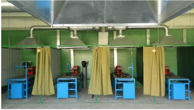
Рис.2.1 Облаштування робочих приміщень для зварювання
