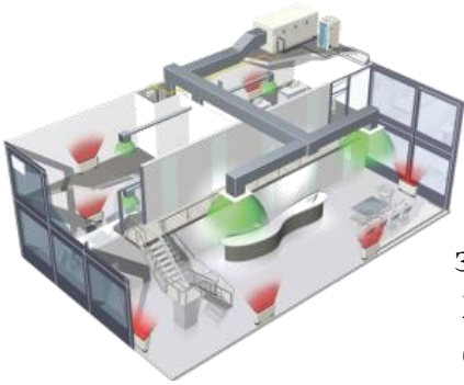
Рис.3.2. Проект вентиляції зварювального цеху
