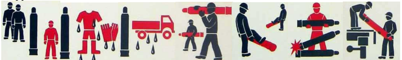
Рис.6.4. Приклади небезпечного транспортування та переміщення балонів
