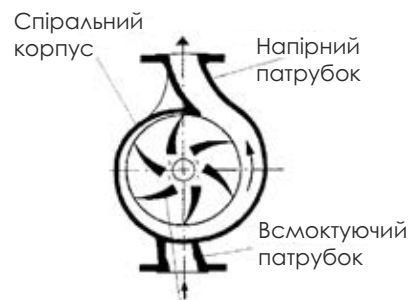
Рис. 56 Крильчатка з викривленими назад лопастями
