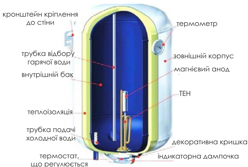
Рис. 102 Будова накопичувального водонагрівача
