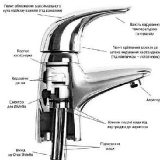
Рис. 36 Загальна будова змішувача води (одноважільний)
