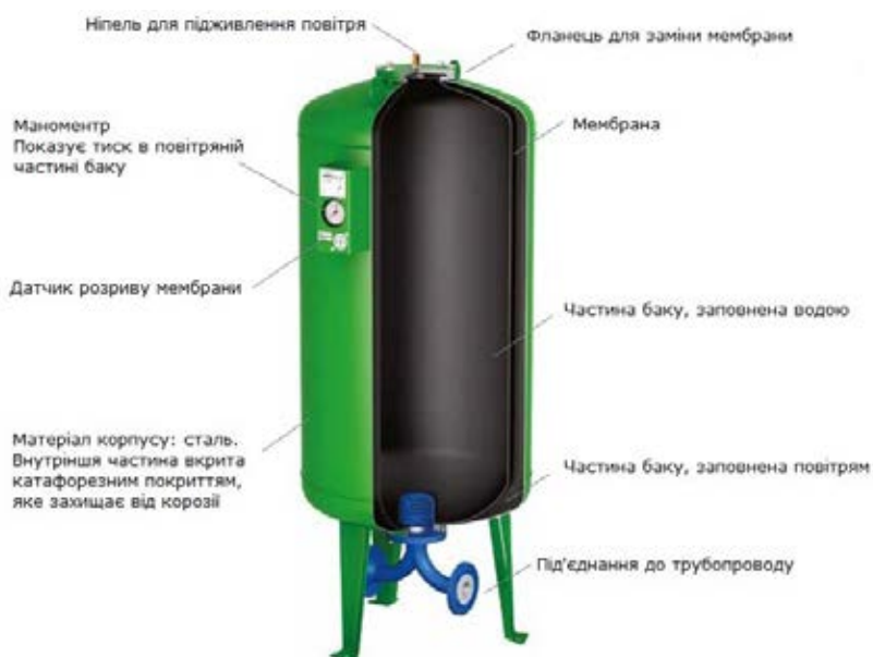
Рис. 59 Будова розширювального бака
