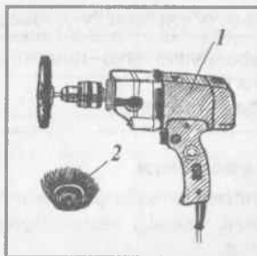
Рис. 41. Електродриль з металевією щіткою: 1 – електродриль з набо- ром металевих щіток, 2 – чашоподібна щітка-насадка
