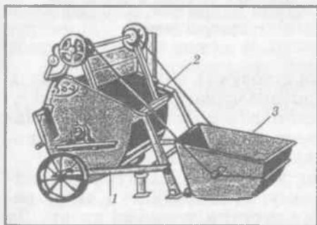
Рис. 56. Малогабаритний розчинозмішувач СО–23А: 1 – тачка, 2 – змішувальний барабан, 3 – підйомник скіповий
