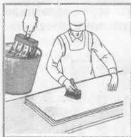
Рис. 114. Нанесення клею на столі макловицею
