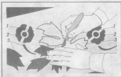
Рис. 51. Вирізання трафаретного малюнка: 1 — містки—перемички, 2 — круглий отвір, пробитий пробійником, 3 — візерунки, вирізані ножем
