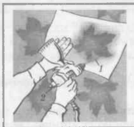
Рис. 58. Нанесення малюнка фарборозпилювачем СО-6А через прямий трафарет:
