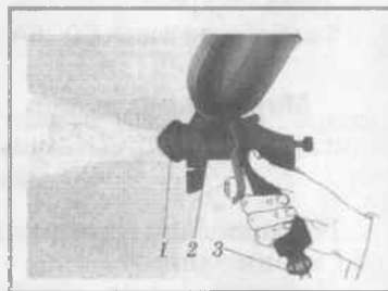
Рис. 35. Набризок з використанням фарборозпилювача СО-6А
