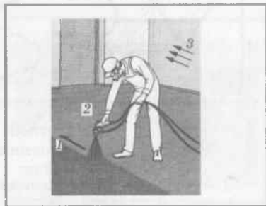
Рис. 15. Фарбування підлоги: 1 – напрям смуг другого шару фарби, 2 – напрям смуг першого шару фарби, 3 – напрям променів світла
