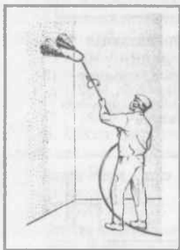
Рис. 82. Фарбування стін за допомогою універсальної дворіжкової вудки
