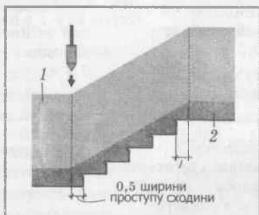
Рис. 27. Розмічання панелей на стінах сходової клітки: 1 — панель, 2 — колошник
