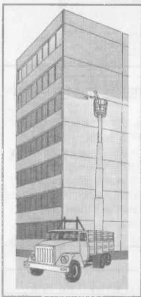
Рис. 83. Фарбування фасаду водно-дисперсною фарбою з автомобільної вишки
