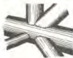
Рис. 20.25. З'єднання труб, підготовлене до зварювання
