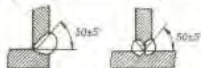
Рис. 7.12. Зварювання кутових швів: а — із скосом однієї кромки (однобічний); б — із скосом двох кромки (двобічний)
