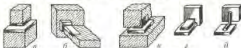
Рис. 20.35. Монтажні зварні з'єднання збірних залізобетонних елементів
