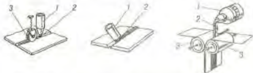
Рис. 18.8. Схема зварювання термопласти екструдованою присадкою: 1 — екструдер; 2 — розплавлений матеріал; 3 — рамка
