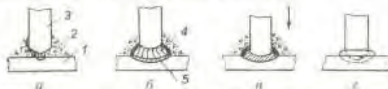
Рис. 12.17. Послідовність операцій при приварюванні шпильок і стрижнів під флюсом
