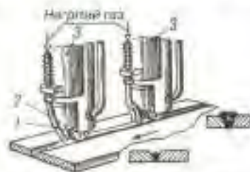
Рис. 18.6. Загальний вигляд механізованого зварювального вузла і зварювальної головки: 1 — сопло; 2 — присадковий матеріал; 3 — зварювальна головка
