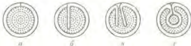
Рис. 6.1. Поперечний переріз порошкових дротів
