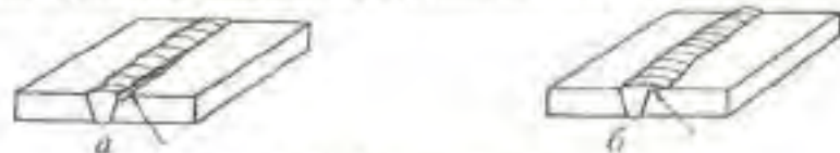
Рис. 22.4. Дефекти зварних швів: а – підріз б – напил
