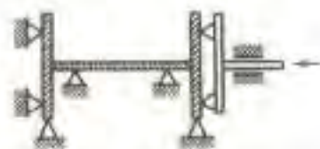
Рис. 20.6. Схема кондуктора для збирання двотаврової балки
