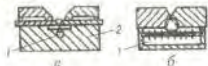
Рис. 9.18. Схеми газових подушок: а, б - одно- і двобічне зварювання; 1 - захисний газ; 2 - мілка підкладка
