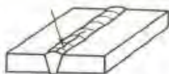
Рис. 22.8. Подовжнє гаряча тріщина
