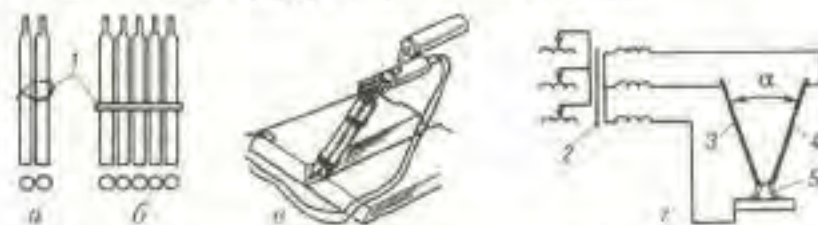
Рис. 13.1. Зварювання спареним електродом, гребінкою електродів і трифазною дугою:
