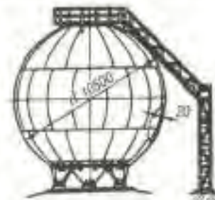
Рис. 20.51. Сферичний резервуар об'ємом 600 м 3
