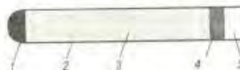
Рис. 6.5. Зварювальний олівець: 1 – запалювальна головка; 2 – тіло; 3 – екзотермічна суміш; 4 – різ; 5 – прорізна для вставки тримача
