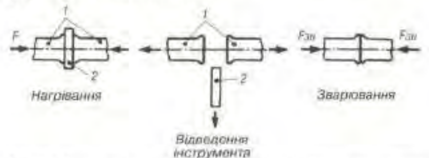
Рис. 18.1. Схема контактного теплового зварювання нагріваним інструментом 1 – поверхні деталей; 2 – нагріваний інструмент
