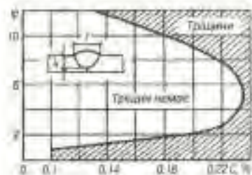
Рис. 22.9. Вплив коефіцієнта форми шва v = \frac{h}{b} і вмісту вуглецю C на можливість утворення тріщин
