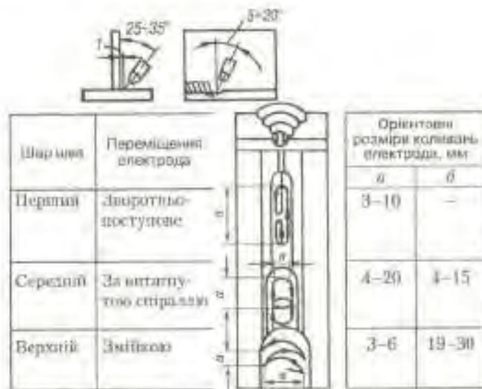
Рис. 9.20. Положення наконечника напівавтомата і прийоми переміщення електрода при зварюванні у вуглекислому газі в нижньому положенні
