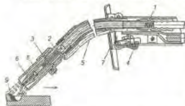
Рис. 9.12. Схема пальника шлангового напівавтомата А-1157П:
