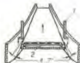
Рис. 20.14. Схема підводу струму в зону зварювання; 1, 2 — ковзаючі контакти
