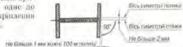
Рис. 20.5. Допуски на збирання Н-подібного перерізу
