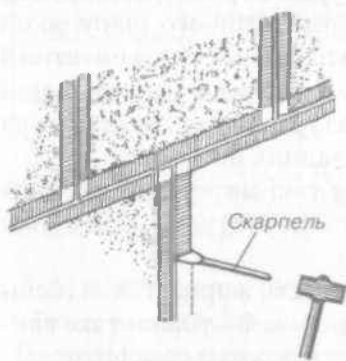
Рис. 56. Оброблення стрічок по краю каменю
