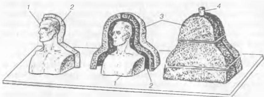
Рис. 156. Виготовлення клейової форми з круглої скульптури:
